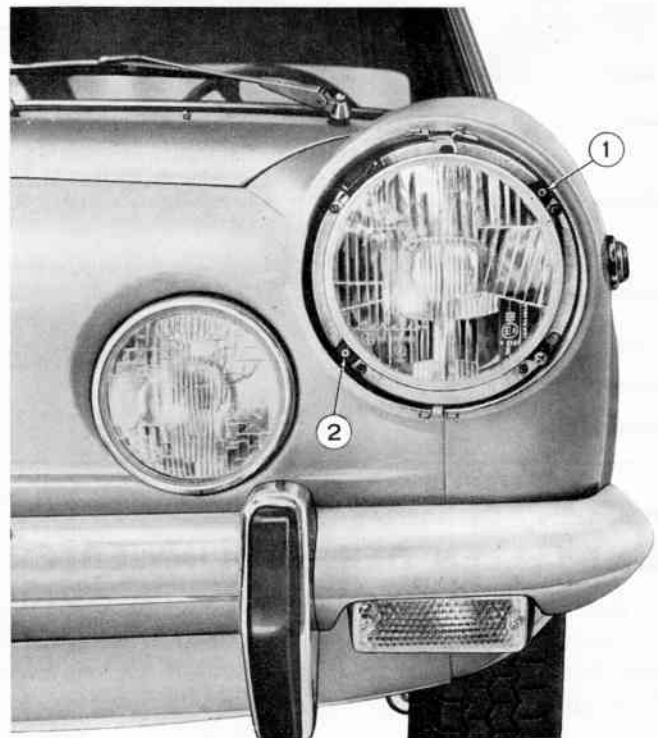
Abb. 96. - Linker Scheinwerfer für Fern- und Abblendlicht bei abgenommenem Deckelring.
