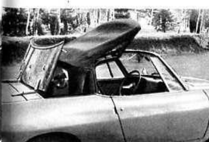
PFIFF MIT DECKEL: Das Spider-Verdeck verschwindet zusammengeklappt unter dem Deckel. Die Türen haben Knopfverschluß statt Griffe.
