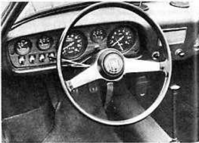
SPORTLICH sind die Armaturen des Spider: Tacho und Tourenzähler sowie Meßuhren für Öl, Wasser und Benzin — wie bei einem kleinen Ferrari.
