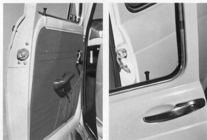
Türschlösser dreifach gesichert, um ein plötzliches Öffnen der Türen bei Unfällen zu vermeiden.
