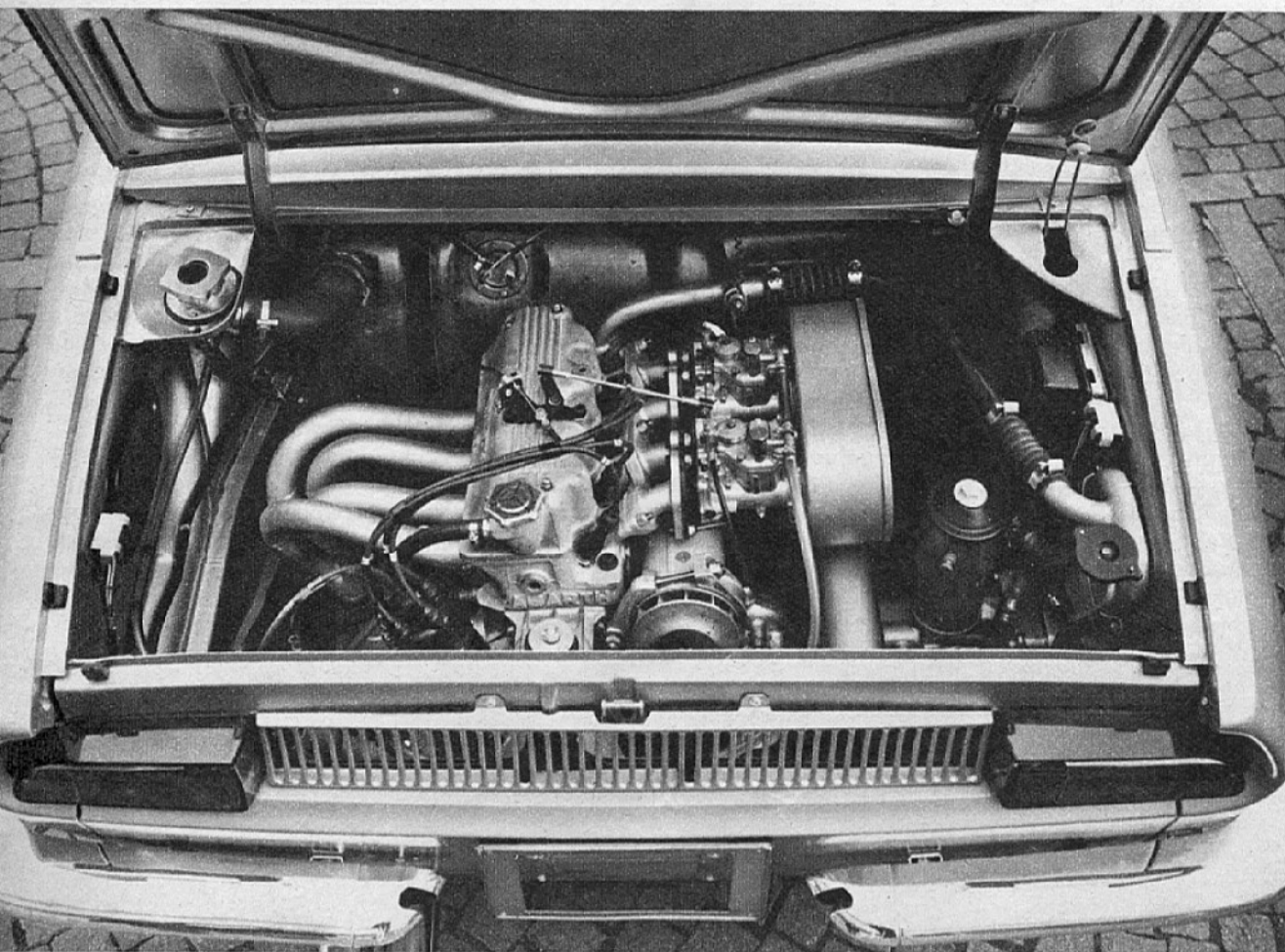
Ein Blick unter die Motorhaube des Fiat Abarth OTR 1000 (Außenansicht siehe Seite 34/35) verrät die sportlichen Ambitionen des kleinen Flitzers. Abarth entwickelte für diesen Motor einen eigenen Zylinderkopf mit vier getrennten Ansaugkanälen, der die Verwendung von zwei Solex-Doppelvergäsern ermöglicht.
