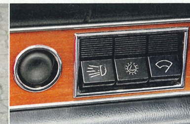
Der Kofferraum hat ein Volumen von 130 Litern. Links neben den Schaltern für Licht, Instrumentenbeleuchtung und Scheibenwischer liegt der Pumpknopf fürs Wischwasser. Wegen des Heckmotors sitzt der Choke zwischen den Sitzen. „Sport“ heißt das Coupé erst ab der zweiten Serie
