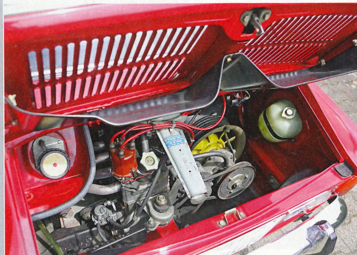
Links oben der Tankstutzen mit Kleckerschutz, rechts vom Motor der Lüfter. Erkennungszeichen der zweiten Serie: die Abrisskante am Heck. Kleines Designschmankerl: das hintere Ausstellfenster mit Chromrahmen
