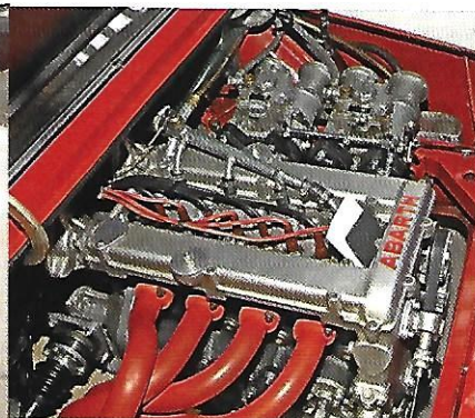
Rezept: Doppel-Weber, Doppelzündung, Doppelnocken. Das marschiert
