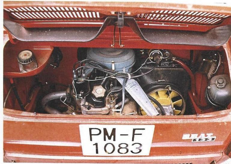
Der 37 PS starke Vierzylinder aus dem 850 sitzt weit hinter der Hinterachse und sorgt in Kurven für eine Hecklastigkeit, die schnell heikel wird
