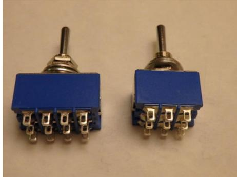
Der Kippschalter wird benötigt, um zwischen dem Serienwischerschalter und dem Scheibenwischerintervallschalter umschalten zu können. Der Scheibenwischerintervallschalter kann nämlich nicht auf Dauerbetrieb schalten. Des Weiteren unterbricht der Kippschalter mit der dargestellten Schaltung auch die Stromzufuhr zur Regelelektronik des Scheibenwischerintervallschalters. Ich denke, es ist schonender für die Elektronik, nicht permanent unter Strom zu stehen.
