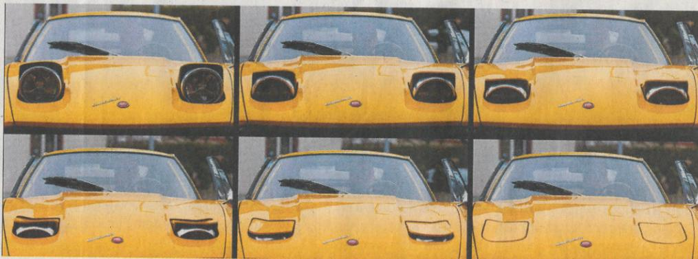
Die Klappscheinwerfer werden elektrisch aus- und eingefahren.
