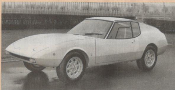
Auf der Basis des Fiat 850 entwickeltes Coupé mit Heckmotor. Erste Exemplare verfügten über eine unkonventionelle Türfensterkonstruktion ähnlich zu Wettbewerbsfahrzeugen, die bei späteren Wagen normalen Kurbelfenstern wichen.
