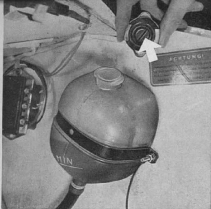
Der Kühlwasserstand soll bei kaltem Motor etwa 7 cm über der Minimum-Marke des Ausgleichgefäßes stehen. Damit je nach Motorwärme ungehindert Kühlflüssigkeit in den oder aus dem Motor strömen kann, zeigt der Verschlußdeckel des Ausgleichgefäßes außen zwei kleine Bohrungen und innen ein Gummilippen-Ventil (weißer Pfeil), das Luft zu- und abströmen läßt, aber Verschmutzung verhindert.
