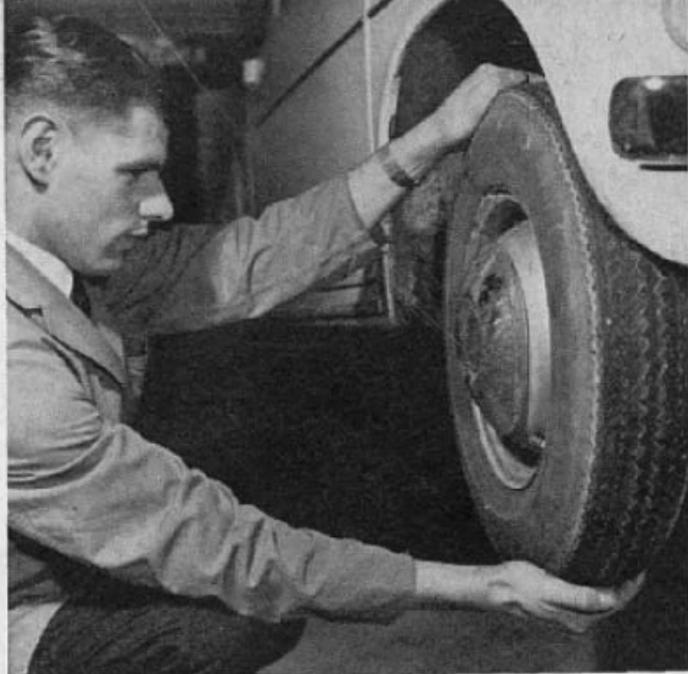
Schmutz und Nässe durchlässig, und die Fettdauerfüllung geht verloren. Die Gummibälge müssen ersetzt werden, wenn sie schadhaft, also nicht vollkommen trocken sind. In diesem Fall müssen auch die entsprechenden Kugelenke auf übermäßiges Spiel hin geprüft werden. Durch Fettmangel oder eingedrungenen Schmutz beschädigte Gelenke müssen ersetzt werden.
