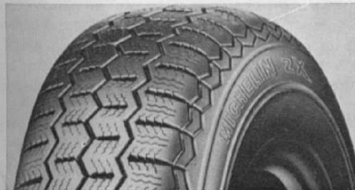
Längere Kilometer-Laufleistungen und eine wesentlich bessere Straßenlage erreicht man mit Radial-Reifen, die auf den Wagen mit 52-PS-Motor schon serienmäßig montiert werden. Der hier gezeigte Michelin-ZP-Reifen ist auch als Austausch-Reifen für ältere 850 sehr geeignet, die noch nicht auf Gürtelreifen im Fahrwerk »abgestimmt« waren. Die für jedes 850-Modell passenden Gürtelreifen-Größen sind auf Seite 197 aufgeführt.
