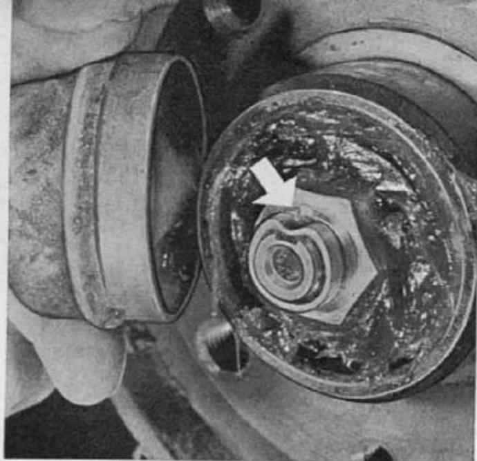
Alle 20 000 km sollen die Vorderradlager und alle 30 000 km die Hinterradlager frisches Fett (Wälzlagerfett) erhalten. Überlassen Sie diese Arbeiten getrost Ihrer Fiat-Werkstatt. Denn bei dieser Gelegenheit werden die Kegelrollenlager, das Radlagerspiel, die Bremsbacken, die Bremszylinder überprüft und das sind alles Arbeiten, die spezieller Erfahrung bedürfen, abgesehen davon, daß dazu Spezialwerkzeug benötigt wird, dessen Anschaffung sich für diese seltenen Arbeiten nicht lohnt.
