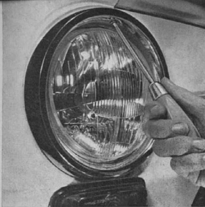
Um eine defekte Scheinwerferlampe auszuwechseln oder den Lichtstrahl des Scheinwerfers genau richten zu können, muß zuerst der äußere Chromzier-ring mit einem Kreuzschlitzschraubenzieher oben innen losgeschraubt werden. Der Chromring läßt sich dann ohne weiteres abziehen. Die darunter sichtbar werdenden Schrauben sind im Bild auf Seite 134 gezeigt.
