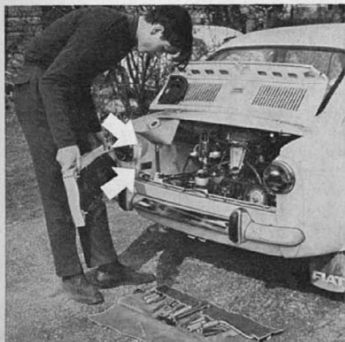
Um am Motor des Fiat 850 leichter montieren zu können, läßt sich ohne Schwierigkeiten das Heckblech ausbauen. Es wird beidseitig von je zwei Sechskantschrauben (weiße Pfeile zeigen auf linke Heckblechbefestigung) gehalten.
