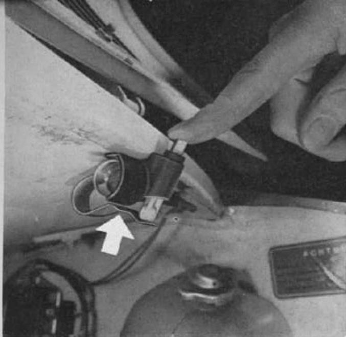
Bei der Motorraumleuchte drückt die schließende Motorhaube, wie hier der Finger, auf den Schalterstift, wodurch die Kontaktzunge (weißer Pfeil) vom Lampenkontakt getrennt wird. Bei fehlendem Druck auf den Kontaktstift berührt die Kontaktzunge den Lampensockel, so daß der Stromkreislauf (bei eingeschalteter Beleuchtung) geschlossen ist und die Lampe brennt.
