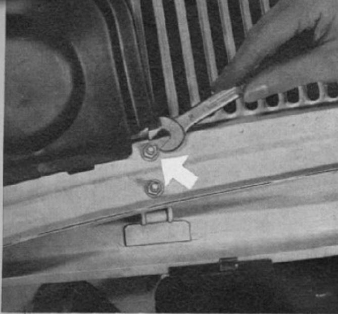
Auch zum Ausbau der Motorraumhaube wird der Schraubenschlüssel SW 10 benötigt, um beidseitig an den Scharnieren die Sechskantschrauben zu lösen. Sie sind nur zu lockern, wenn die Motorhaube schief im Haubenausschnitt sitzt und nicht rundum flächenglatt anliegt. Die Scharnierschrauben sitzen in sogenannten Langlöchern (weißer Pfeil), die ein Verschieben der Haube ermöglichen.
