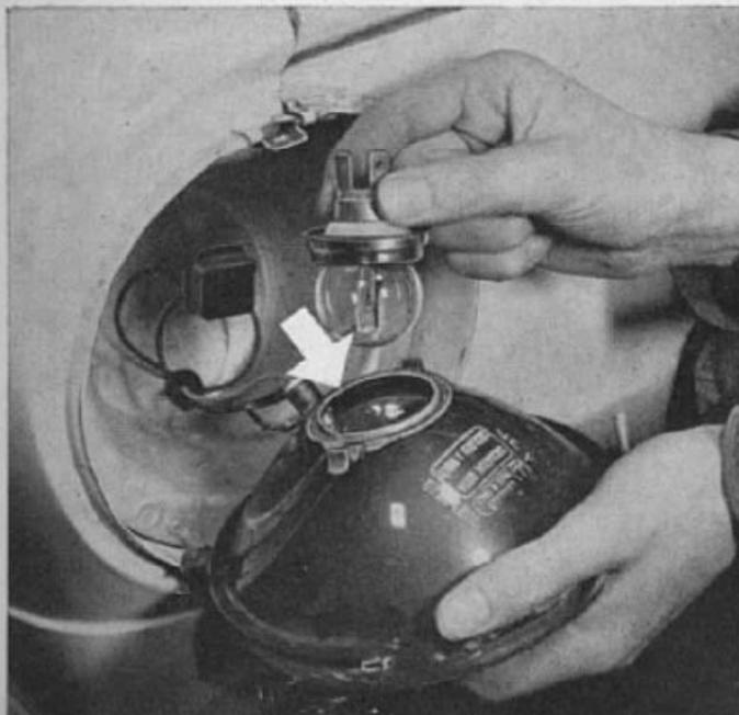
Beim Einsetzen einer Glühlampe in den Scheinwerferspiegel ist darauf zu achten, daß ein kleiner Nocken am Lampensockelrand genau in die entsprechende Aussparung im Scheinwerferspiegelrand (weißer Pfeil) zu sitzen kommt. Andernfalls sitzt die Lampe schief im Scheinwerfer und der Scheinwerferstrahl stimmt nicht, wobei man zum Zusammenbau mit Gewalt außerdem die Federklammern am Lampensockelhalter verbogen hat.
