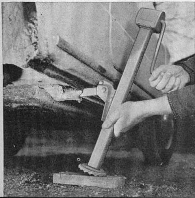
So wird der Wagenheber exakt angesetzt, damit er beim Hochkurbeln nicht so leicht umkippt: Schräg nach außen stehend, von der Seite gesehen, jedoch haargenau senkrecht, den Tragbolzen bis zum Anschlag in die Hülse der Quervertraverse geschoben und auf dem Boden ein Unterlegebrettchen, damit sich der Wagenheberfuß nicht in den Boden drückt (anstatt den Wagen hochzuheben). Der schräg nach außen stehende Wagenheber kommt beim Hochkurbeln immer mehr in die Senkrechte.
