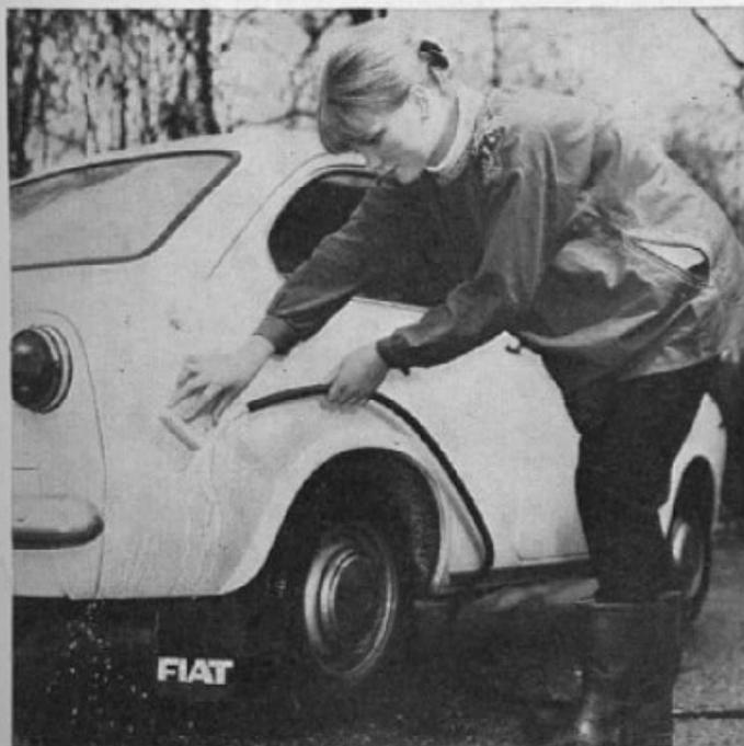
Bei der Schlauchwäsche muß trotz der Forderung nach viel Wasser die nächste Umgebung nicht überschwemmt werden. Der Wasserstrahl soll nur sanft an der Stelle fließen, die gerade bearbeitet wird. Ein scharfer Wasserstrahl ist, abgesehen von der Reinigung der Felgen und Radkästen, sowieso nicht gut, denn er reißt die Schmutzteilchen über den Lack, so daß hauchfeine Kratzer entstehen, die mit der Zeit dem Lack seinen Glanz nehmen.
