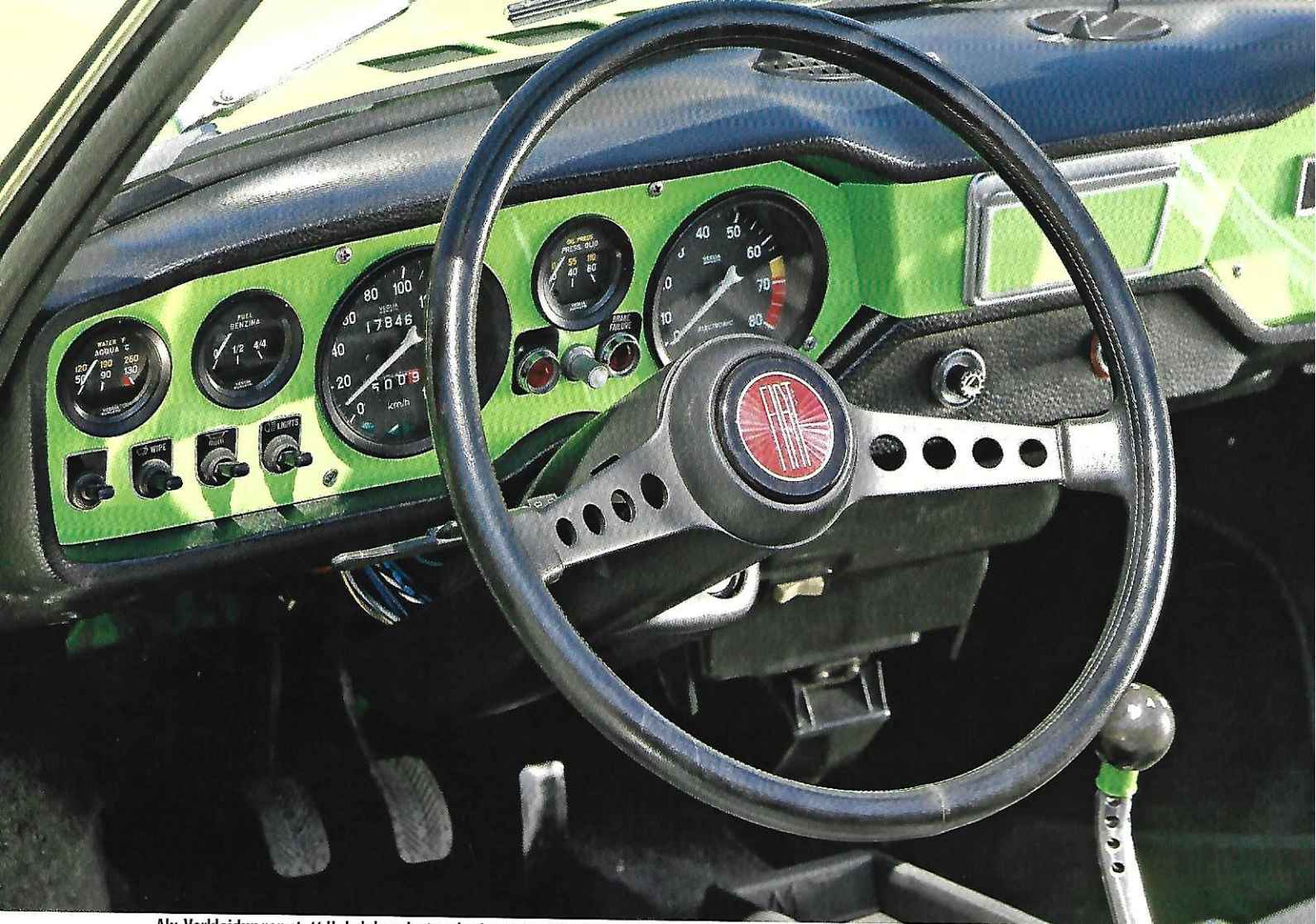
Alu-Verkleidungen statt Holzdekor zierten das Instrumentenbrett ab 1972. Da diese beschädigt und neu nicht zu haben waren, lackierte Thoma das Blech in Wagenfarbe
