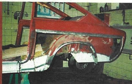
Vorm Schweißen wurden die Hohlräume grundiert, lackiert und mit Schweißprimer behandelt
