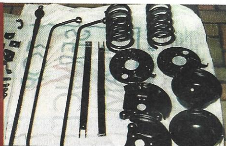
Gestrahlt, zinkphosphatiert, kunststoffbeschichtet: Auch das Fahrwerk geriet vom Allerfeinsten
