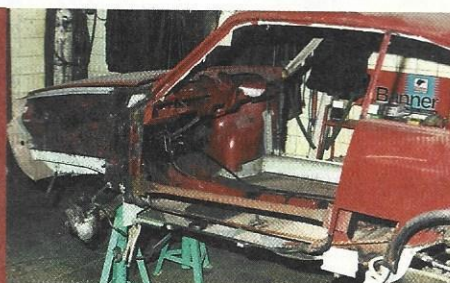
...innen und außen, A-Säulen, Radläufe, Endspitzen und Bodenblech waren unrettbar...
