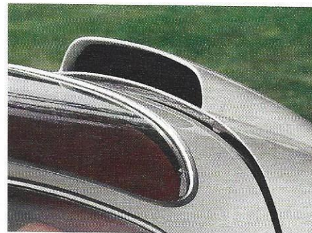
Die eigenwillige Hutze auf der Motorhaube dient einer effektiven Triebwerks-Beatmung
