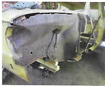
Stehblech, Lampentopf, A-Säule und Schweller hat der Rost dahingerafft
