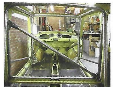
Die Stabilität der Fahrgastzelle steigert ein verschweißter Stahlrohrkäfig
