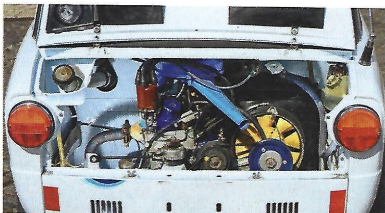
Der 37-PS-Vierzylinder-Reihenmotor hat längs im Heck Stellung bezogen. Die Achillesferse des drehfreudigen Triebwerks mit viel Tuning-Potential ist die Kühlung
