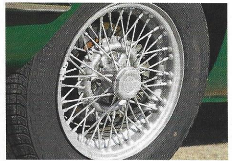
Man vermutet sie eher auf britischen Roadstern, doch die Borrani-Speichenräder sind Originalzubehör „Made in Italy“
