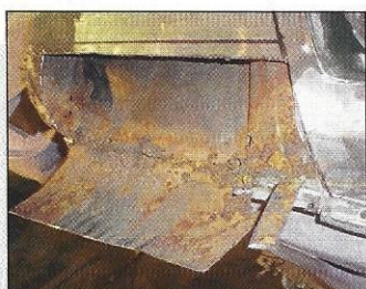
Für Fiat-Verhältnisse prima: Die Karosserie wies zwar etliche kleine und mittlere Durchrostungen auf, doch dafür, dass der Wagen die meiste Zeit seines Lebens in den Niederlanden und nicht im sonnigen Süden verbrachte, war die Karosserie ausgesprochen gut bei einander! Die Enden der Außenschweller (l.) gehören zu den üblichen Schwachpunkten, das Bodenstützkreuz (r.) ebenso. Unter zähem Bitumen hat es sich gut gehalten
