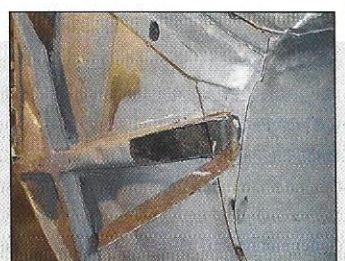
Für Fiat-Verhältnisse prima: Die Karosserie wies zwar etliche kleine und mittlere Durchrostungen auf, doch dafür, dass der Wagen die meiste Zeit seines Lebens in den Niederlanden und nicht im sonnigen Süden verbrachte, war die Karosserie ausgesprochen gut bei einander! Die Enden der Außenschweller (l.) gehören zu den üblichen Schwachpunkten, das Bodenstützkreuz (r.) ebenso. Unter zähem Bitumen hat es sich gut gehalten
