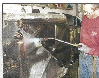
Für Fiat-Verhältnisse prima: Die Karosserie wies zwar etliche kleine und mittlere Durchrostungen auf, doch dafür, dass der Wagen die meiste Zeit seines Lebens in den Niederlanden und nicht im sonnigen Süden verbrachte, war die Karosserie ausgesprochen gut bei einander! Die Enden der Außenschweller (l.) gehören zu den üblichen Schwachpunkten, das Bodenstützkreuz (r.) ebenso. Unter zähem Bitumen hat es sich gut gehalten
