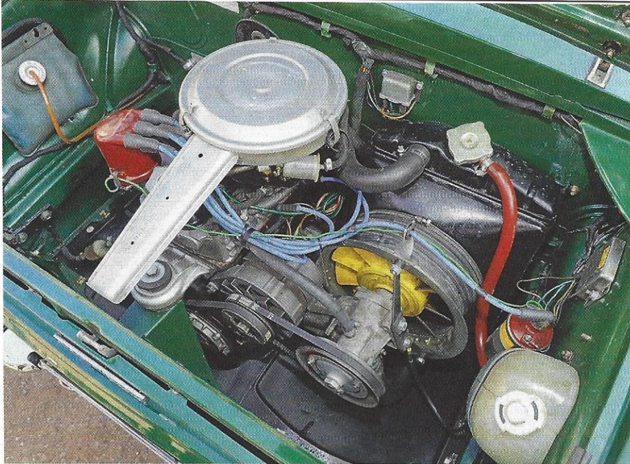
903 Kubik, 52 PS bei 6400 Touren: Der linksdrehende (!) Stoßstangen-Vierzylinder (B x H: 65 x 68 mm) ist robust und drehfreudig
