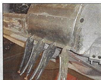
Für Fiat-Verhältnisse prima: Die Karosserie wies zwar etliche kleine und mittlere Durchrostungen auf, doch dafür, dass der Wagen die meiste Zeit seines Lebens in den Niederlanden und nicht im sonnigen Süden verbrachte, war die Karosserie ausgesprochen gut bei einander! Die Enden der Außenschweller (l.) gehören zu den üblichen Schwachpunkten, das Bodenstützkreuz (r.) ebenso. Unter zähem Bitumen hat es sich gut gehalten
