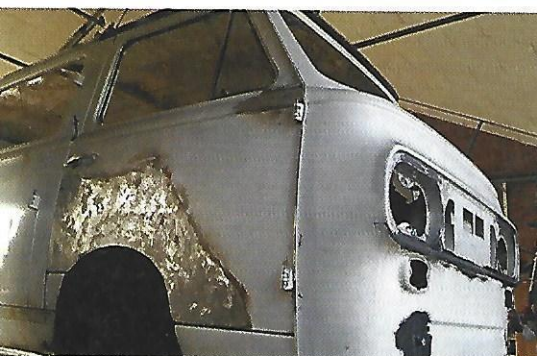
In Arbeit: Nahezu jeder 850-Bus hat rostige Türen – deren Unterkante ist zugleich der vordere Radlauf
