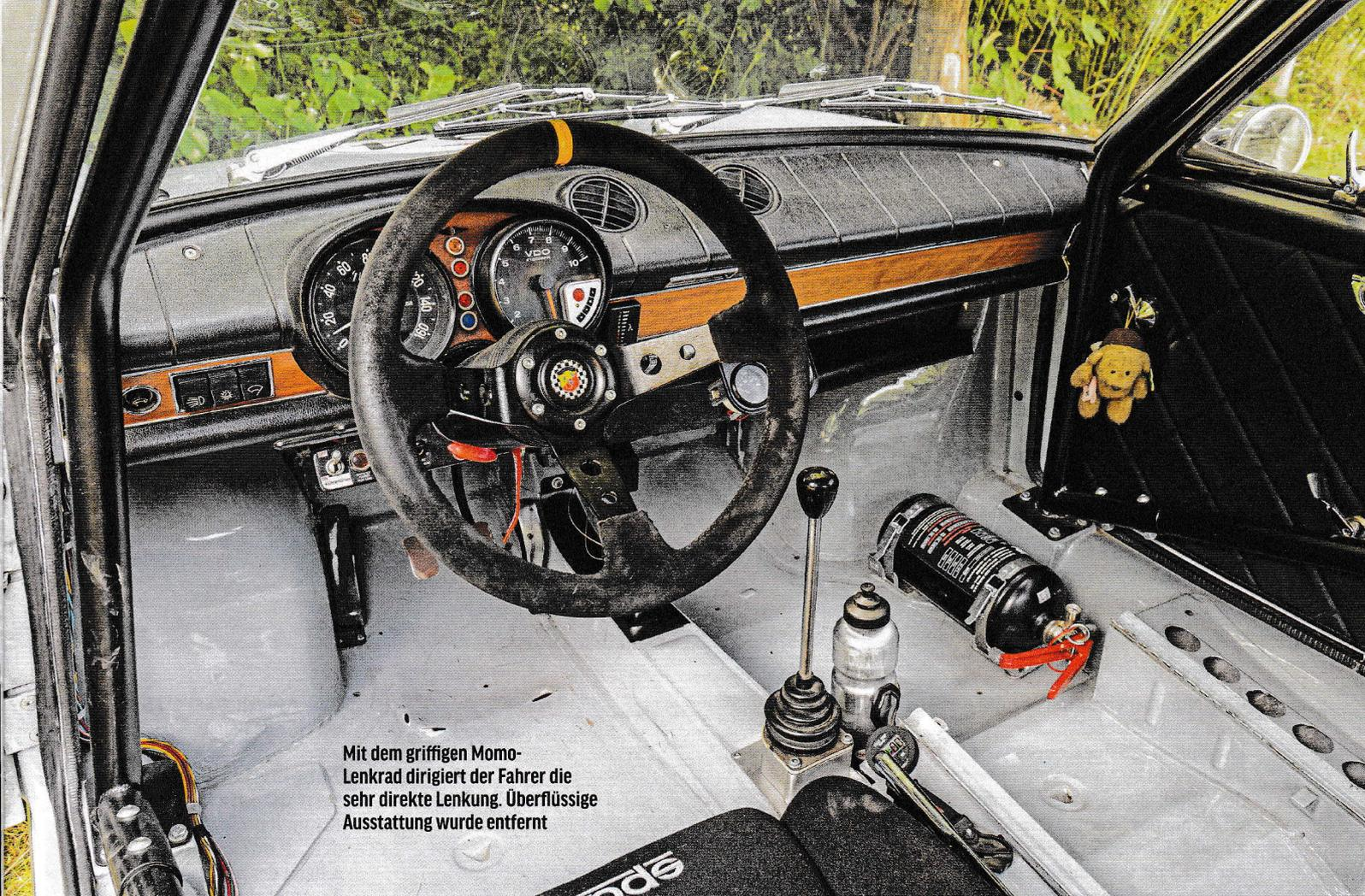
Mit dem griffigen Momo-Lenkrad dirigiert der Fahrer die sehr direkte Lenkung. Überflüssige Ausstattung wurde entfernt
