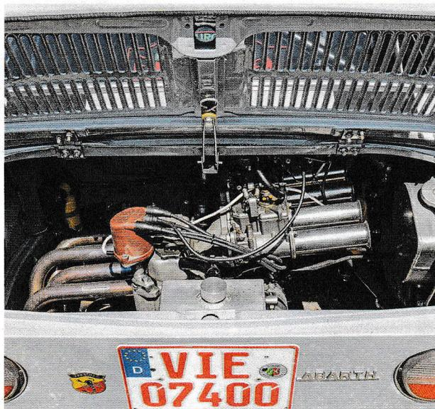
Das 1000-cm<sup>3</sup>-Kraftpaket speisen zwei 40er-Weber DCOE-Vergaser, es leistet 115 PS und ermöglicht je nach Übersetzung bis zu 188 km/h Spitze
