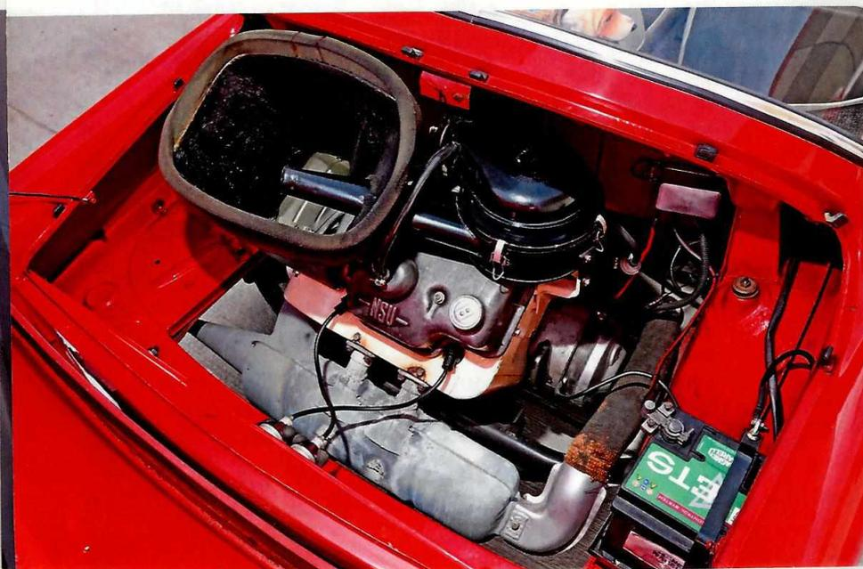
Der luftgekühlte Parallel-Twin macht viel Lärm, überträgt Vibrationen und bildet mit 30 PS das Leistungs-schlusslicht im Vergleich
