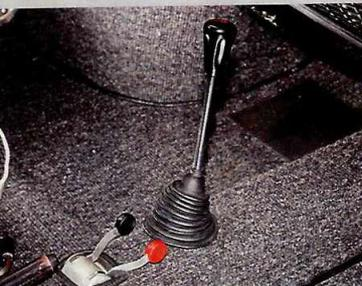
Heizungs- und Chokehebel sind auf dem Mittelunnel angeordnet. Der Schaltvorgang braucht etwas Zeit
