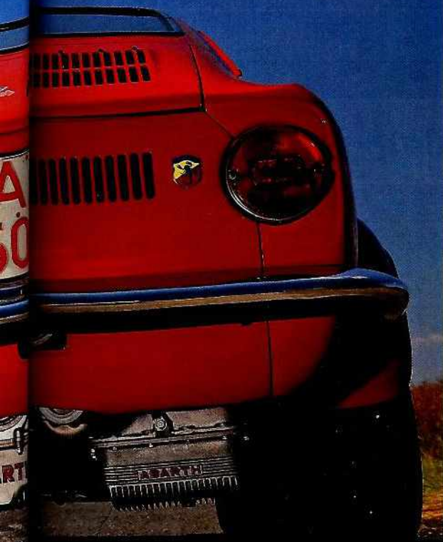
Zwei Ölwanne beim America Coupé: Unter dem Trockensumpf (rechts) und unter der Kurbelwelle. Sie sollen das im Rennbetrieb schäumende Öl beruhigen, bevor es zurück in den Motor fließt
