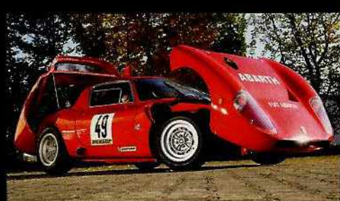
Kunstwerk von 1965. Der spektakuläre OT 1300 mit Fiberglaskarosserie und riesigen Hauben baut auf dem Simca 1000 auf. Der kleine Belüftungs-Schnorchel auf dem Dach wird sein Markenzeichen
