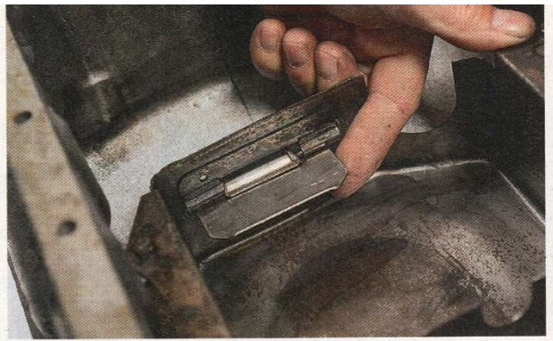
Diese Klappe im Schwallblech der Ölwanne kann sich manchmal lösen. Meist merkt man dies eher zufällig beim Erneuern der Ölwanneichtung
