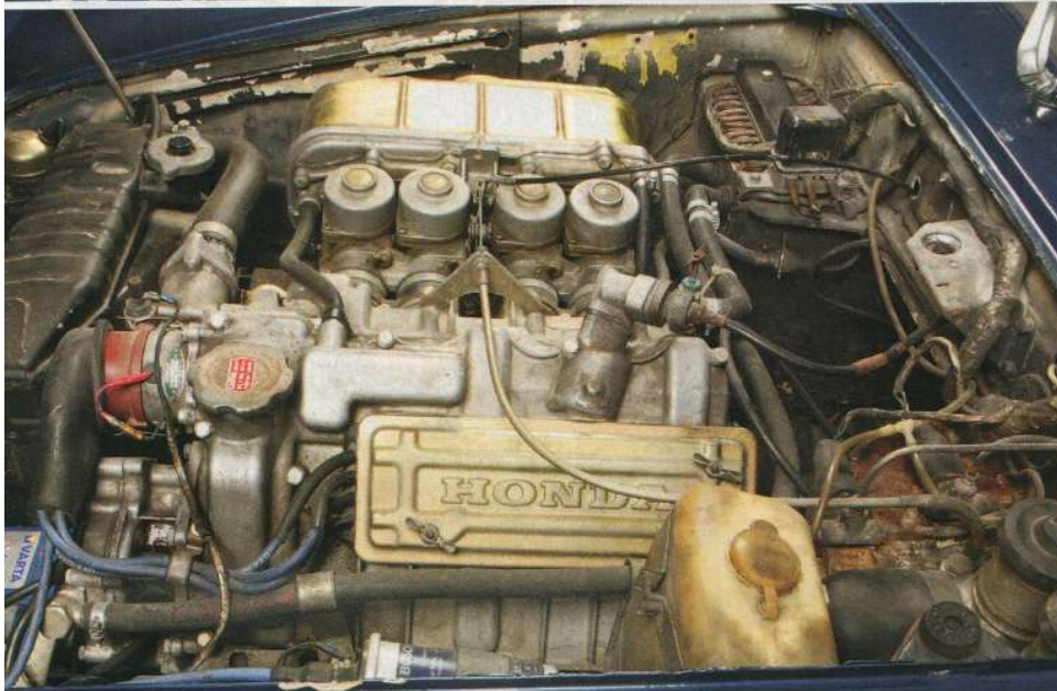
1966 eine echte Kampfansage: Der DOHC-Vierzylinder mit vier Keihin-Vergasern und nadelgelagerter Kurbelwelle garantierte Drehzahlen bis der Arzt kommt
