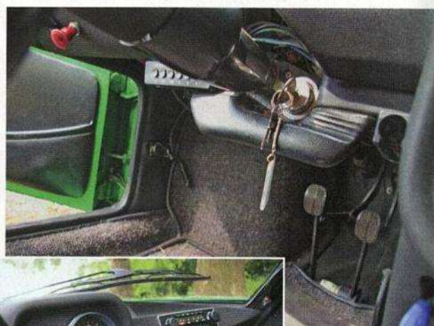
Gewusst wie: Als Kniepolster wurde werkseitig ideenreich ein Türgriff verbaut.
