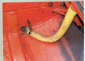
...ist. Innen fallen die Sünden eines Amateurschweißers sofort ins Auge
