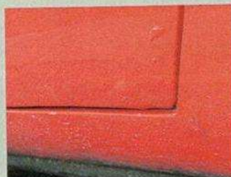
Rost plus Riss an Fahrtür und Schweller verheißen nichts Gutes
