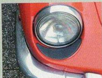
Da hat es mal leicht gerummt, die Stoßstange liegt direkt am Blech an
