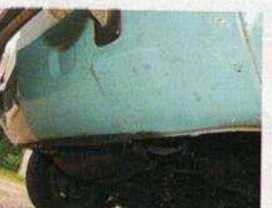
Frontschürze: Die Feinde sind Steinschlag und Kantenrost
