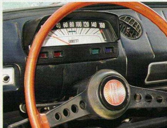
Rustikal: Das Kombiinstrument macht selten Ärger, rissige Armaturenbretter kommen vor. Tauschteile gibt es jederzeit
