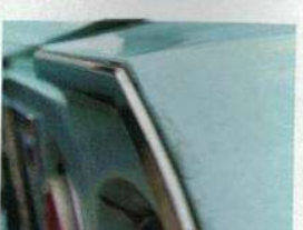
Verräterisch: unter Zierleisten hervorlugende Blasen
