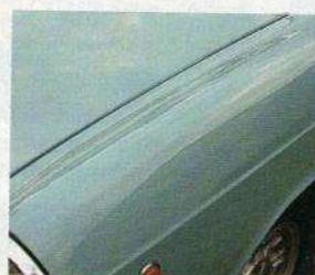
...verschleißt. Die vorderen Kotflügel rosten zur A-Säule...
