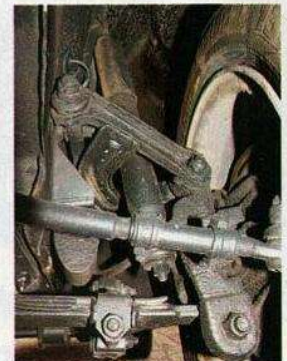
Check vom Fußraum aus: Gammelt die Achsaufnahme?
