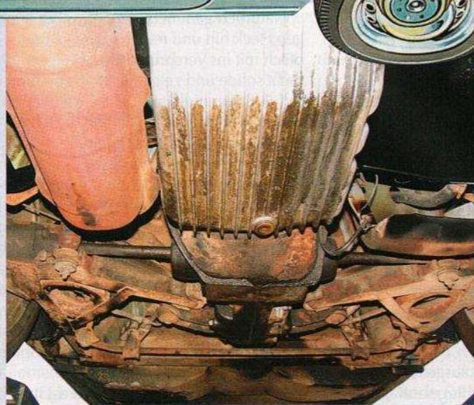
Kein Bagatelproblem: Die vierteilige Ölwanndichtung leckt gern und ist nur mit viel Liebe dicht zu bekommen
