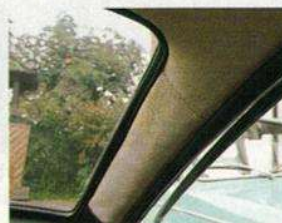
Einbruch durchs Heckfenster: Wasserspuren am Himmel
