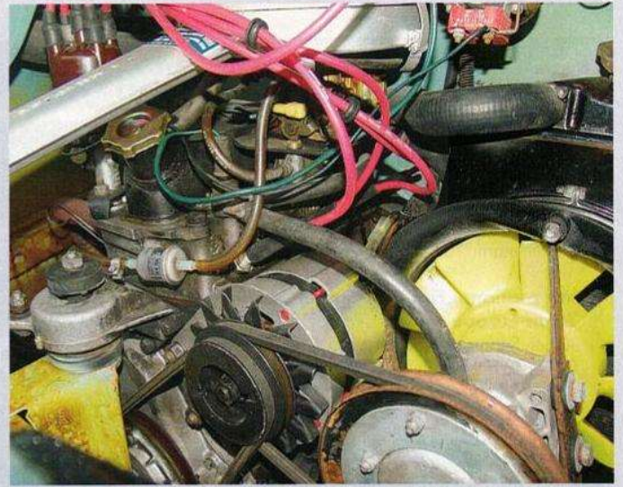
Zähe Zwerg: Die Motoren sind agil, sparsam, zuverlässig, langlebig – und hitzig, wenn Luftbleche fehlen oder der Kühler verschmutzt ist
