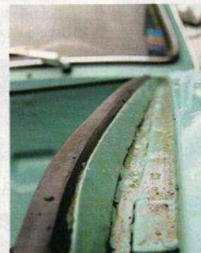
Kotflügelaufgaben: Auch hier nagt Rost an allen Beteiligten
