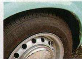
...hinteren Radläufe – mehrlagiges Blech gammelt
