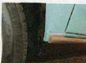
...das gesamte Radhaus und die Schwellerstippen
