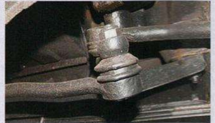
Spurstangenköpfe: Polnische Neuteile sollten vor Einbau gefettet werden
