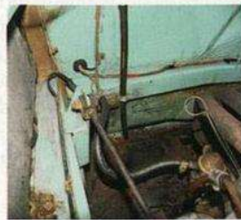
Dank Ölnebels meist intakt: das Blech des Motorraums
