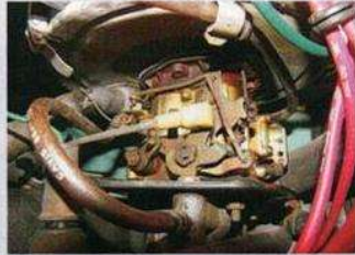
Feuer frei: Bei den Vergasern lösen sich die Benzinschlauchstutzen
