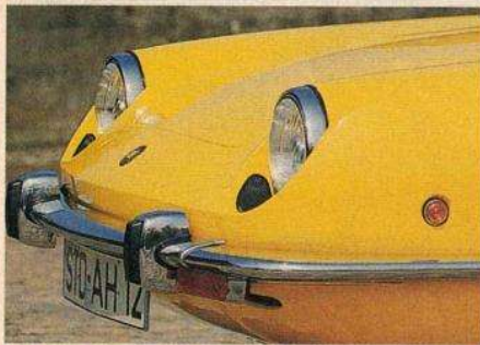
Ab nach Amerika: Die geraden Lampen folgten einer Zulassungsbestimmung des US-Marktes.
