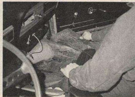
...und zersiebte Innenschweller, eine typische Schwachstelle der selbsttragenden Karosserie.
