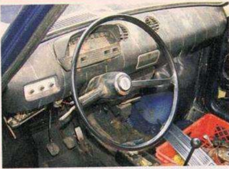
Das Lenkrad stammt vom 850 Standard – es ist stabiler als das originale Lochspeichenexemplar
