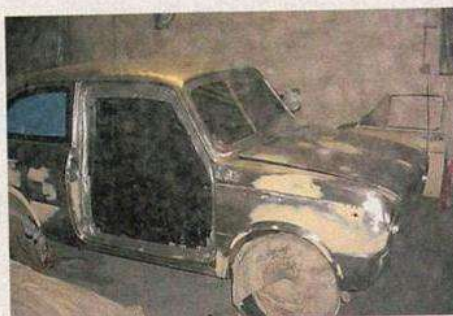
Das alte Farbleid musste inklusive Grundierung weichen – überall waren kleine Rostpickel
